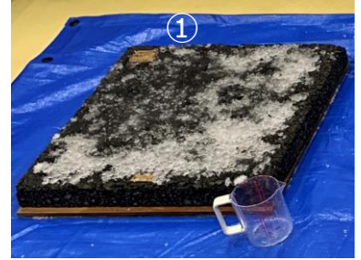
塩化ナトリウム20g散布路面
